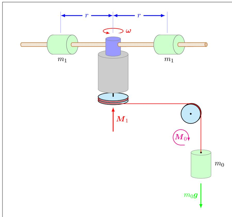
Abbildung 1: Durch Gewicht beschleunigter Rotator.
